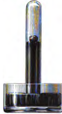
Ein Stück Eis absorbiert Ammoniak sofort unter Verflüssigung.
